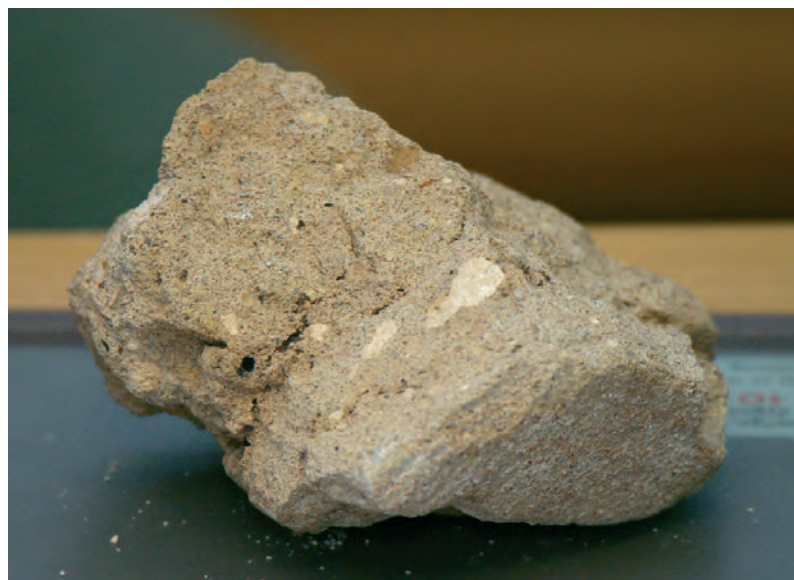
400 år gammalt murbruk med smärre kalkklumpar och träkolsfragment.
