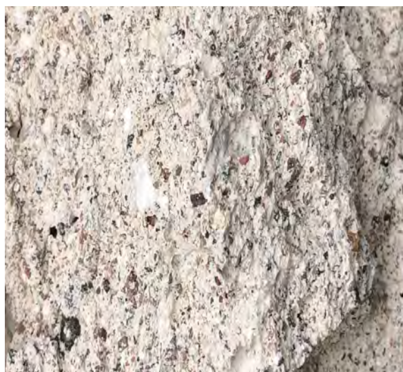
Kalkrika mur- och putsbruk utan krympsprickor med inslag av rostade mjuka kalkklumpar. Båda med lika vikt delar kalk och den ballast som fanns tillhands.
