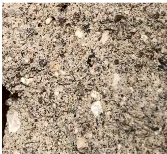
Kalkrika mur- och putsbruk utan krympsprickor med inslag av rostade mjuka kalkklumpar. Båda med lika vikt delar kalk och den ballast som fanns tillhands.
